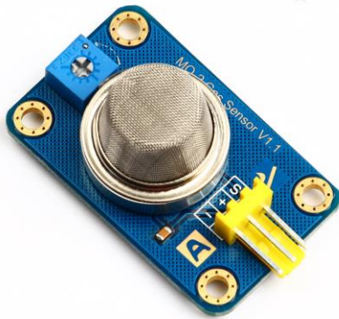
Рис.1 Аналоговий датчик диму MQ-2.
